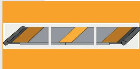
Für das perfekte Tuchbild verwenden wir bei TERRASIGN bereits im Standard die Zip-Führung mit integriertem Gegenzug. Durch unsere Gasdruckelemente wird das Tuch ständig optimal über die gesamte Breite gespannt.
